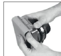
Il n'est pas nécessaire d'acheter des feuilles d'abrasifs au format du plateau de la ponceuse. Il suffit d'acheter des feuilles standard et de les mettre au format voulu : 95 x 230 mm.
