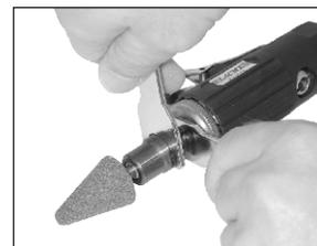
**La meuleuse crayon pro est livrée avec deux clés plates :** 1 clé plate 11 mm et 1 clé plate 17 mm pour le serrage des accessoires dans le mandrin.
