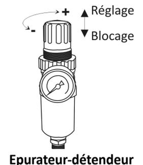
**NB :** Vérifier que la pression de réglage du détendeur soit toujours inférieure à la pression de redémarrage du contacteur manométrique. Sinon, vous n'aurez pas la pression désirée.
