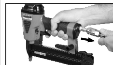
A) Débrancher la cloueuse.
