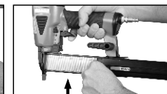
C) Placer les pointes dans le magasin.
