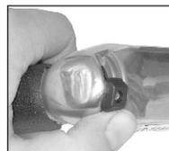
Un régulateur d'air permet de régler le débit d'air à l'entrée de la polisseuse. Plus le débit d'air est important, plus la mini ponceuse aura de puissance (et ce à pression constante).
