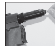
La tête du rivet doit toucher l'embout.
