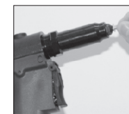
La tête du rivet doit toucher l'embout.
