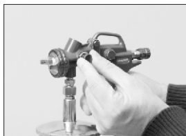
Réglage forme du jet Jet rond / jet plat
