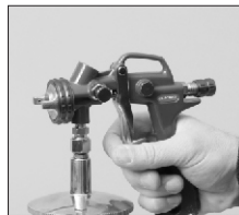
Jet plat vertical (chapeau horizontal)
