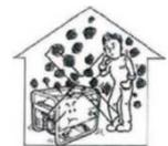
Il est impératif de placer le groupe électrogène dans un endroit ventilé. Ne jamais faire fonctionner le groupe électrogène dans un lieu clos (pièce, intérieur d'une maison, garage voiture, etc.). Le moteur consomme de l'oxygène, et produit du gaz de monoxyde de carbone mortel (gaz inodore). Une ventilation inappropriée provoquera des dommages matériels, de possibles blessures aux êtres vivants, et la mort par asphyxie.
