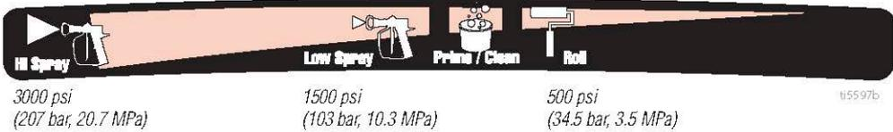
Pour sélectionner la fonction, mettez le symbole figurant sur le bouton de régulation de la pression en face de l'indicateur de réglage situé sur le pulvérisateur.
