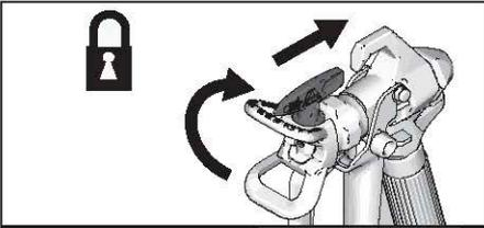
**REMARQUE :** Si la buse de pulvérisation est difficile à pivoter en tournant en position débouchage, suivez la **Procédure de décompression**, page 11, puis tournez la vanne d'amorçage/de pulvérisation en position pulvérisation et répétez l'étape 1.
