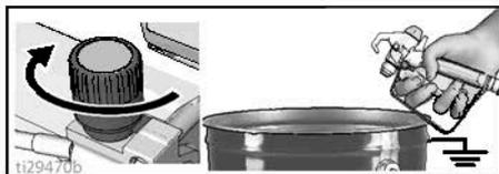
7. Arrêtez d'actionner le pistolet. Approchez le pistolet du seau à déchets, appuyez-le contre le seau et actionnez le pistolet pour rincer soigneusement le pulvérisateur.
