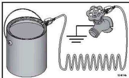
Pour maintenir la continuité de la mise à la terre lors du rinçage du pulvérisateur ou de la décompression : maintenez fermement la partie métallique du pistolet pulvérisateur contre le côté d'un seau métallique relié à la terre, puis actionnez le pistolet.
