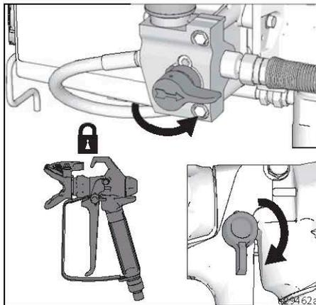
7. Tenez le pistolet contre un seau à déchets métallique mis à la terre. Actionnez le pistolet jusqu'à ce que la peinture apparaisse.
