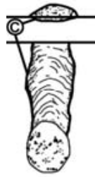
Arc trop long
