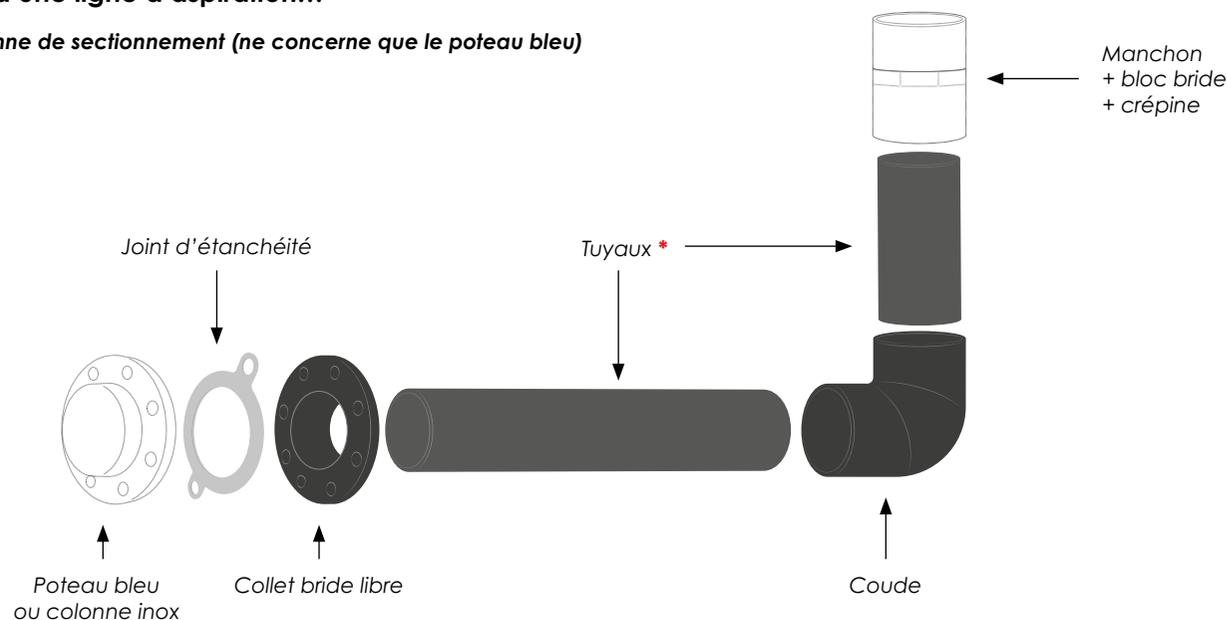
\* Tuyaux PVC-P DN100/D110 non fournis avec la ligne d'aspiration
