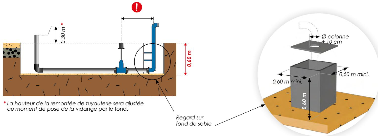
**!** La réglementation impose une distance de 50 cm à 1,00 m entre la colonne et la vanne de sectionnement.
