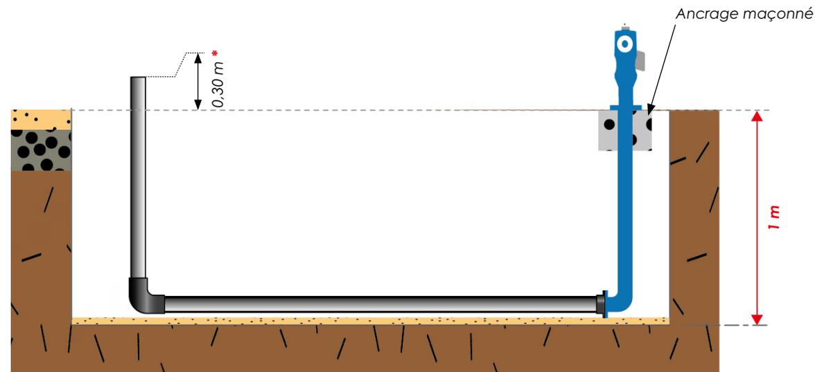
\* La hauteur de la remontée de tuyauterie sera ajustée au moment de pose de la vidange par le fond.
