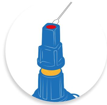
**(2)** Insérez une clé 6 pans pour dévisser et retirer le carré de manœuvre d'origine.
