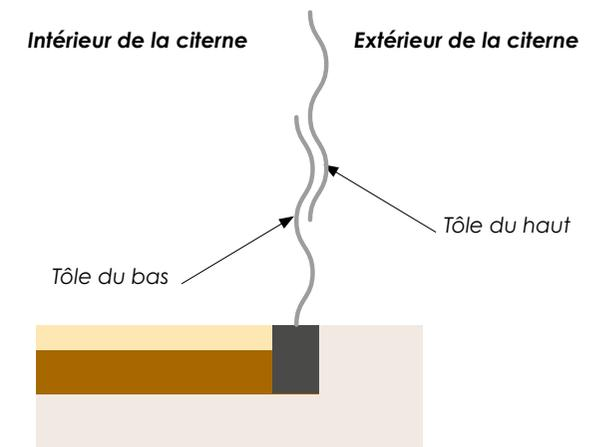
Pour faciliter le montage, utiliser des pointerolles (ou des gros tournevis) pour présenter et positionner les tôles sur la première virole à l'aide des trous de perçage.
