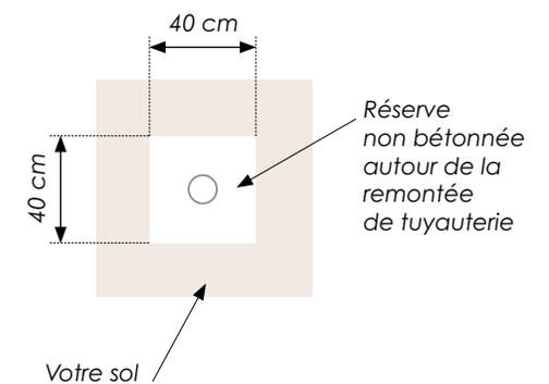
\* La hauteur de la remontée de tuyauterie sera ajustée au moment de pose de la vidange par le fond.
