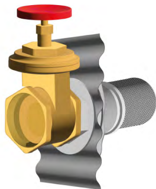
Vidange par le côté Vanne guillotine laiton DN100 Traversée de cloison INOX Crépine INOX
