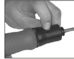
La visseuse droite PM est munie d'un réglage externe du couple de serrage.
