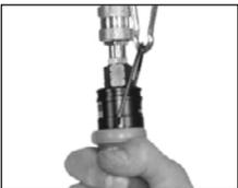
La visseuse est équipée d'un anneau de suspension qui permet d'accrocher la visseuse à un équilibreur qui soulage l'utilisateur lors des travaux de vissage sur poste fixe.
