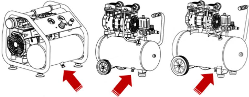
2. Connecter un tuyau pneumatique adapté a la caractéristique du compresseur (notamment la pression maximale admissible), au niveau du raccord rapide. Puis l'outil pneumatique.
