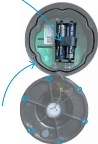
Lors de l'insertion des nouvelles piles dans le support, le capteur effectue une série lumineuse : **Bleu, Blanc , Rouge** puis déclenche une mesure.
