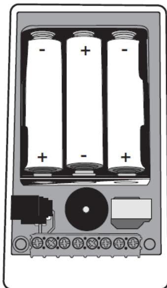
Schéma 4: Alimention électrique de l'alarme de rétention
